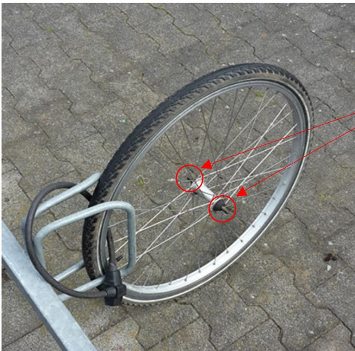
一般自行车的前轮通过两个螺母与前叉相连，只要拧开这两个螺母就可以把除前轮以外的部分整个弄走（如果是装备速拆轴的自行车则这个过程可以实现无工具操作）。与一辆整车相比一个前轮的价格十分有限而且非常容易配到，因此这种只锁前轮的方式安全系数很低
