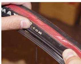
把补好的内胎装回去时，先打入一定程度的气，然后将内胎气嘴插入轮框上的气嘴孔，一点一点小心地把内胎塞回轮框中。塞回内胎后，就可以把外胎卡回轮框至最紧的状态，将轮胎撬杆反向插入，如之前拆卸一样，过程中注意检查左右两侧胎缘与轮框之间是否有夹到内胎，最后一点外胎双指用力向里压入。
