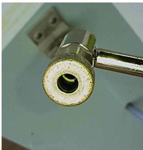
用于美式气门嘴的接口。区别是此种接口有一个顶头（箭头所示），用于顶开美式气门嘴的气阀。顶头的形式也可能是塑料圆柱体，多见于手动气筒上
