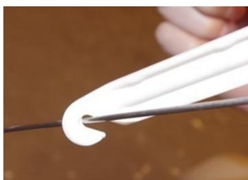
将其中一只轮胎撬杆插入外胎，利用杠杆的原理将外胎翻出后固定不动，撬杆可以挂在辐条上面。把撬杆成扇形打开，顺势绕一圈，将全外胎翻出轮框，必要时用手辅助。翻出外胎之后，将中间的内胎取出来，和气嘴连接的地方最后才取出来。
