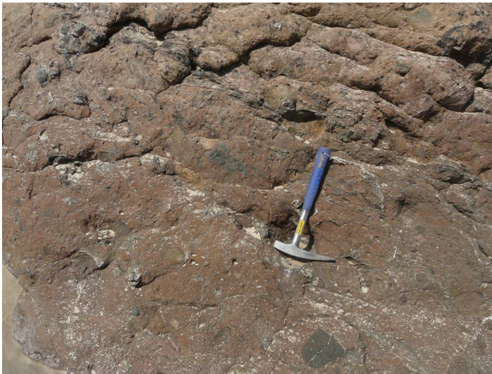
Abb 24a Die Detailaufnahme zeigt schön den breckziösen Charakter, der typisch für Kimberlite ist
