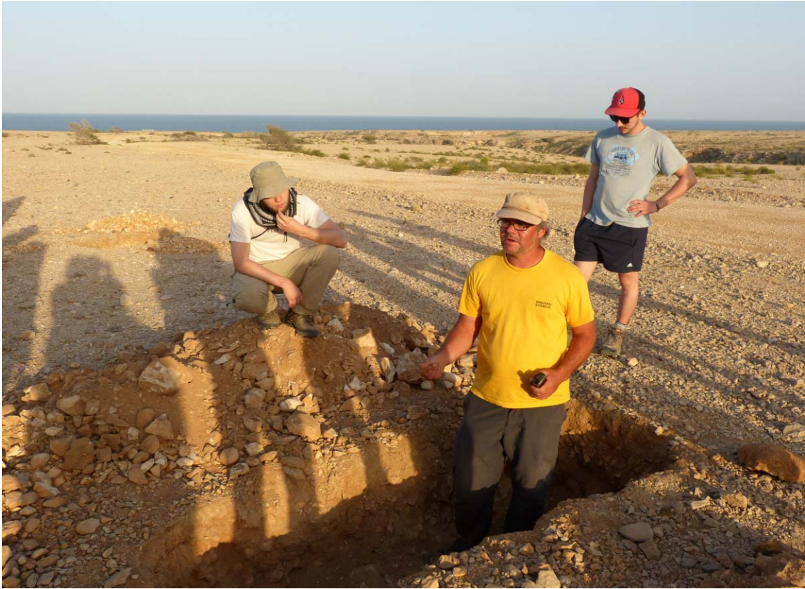
Abb. 9 Grube für Probenahmen zur OSL-Datierung (Optical Stimulated Luminescence) eines Paläo-Strandes
