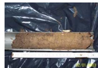
Carolin Thoms bei der Bodenprobenahme mit dem Bodenbohrer „Split tupe“ der Firma Eijkelkanp
