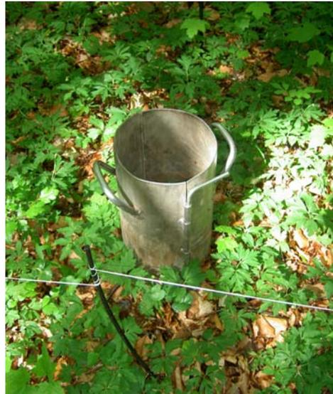
Einschlagbohrer für Streu- und Bodenproben zur Austreibung der Bodentiere
