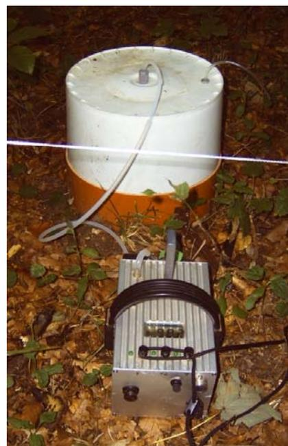
Closed-chamber-Messungen der Methan-Flüsse
