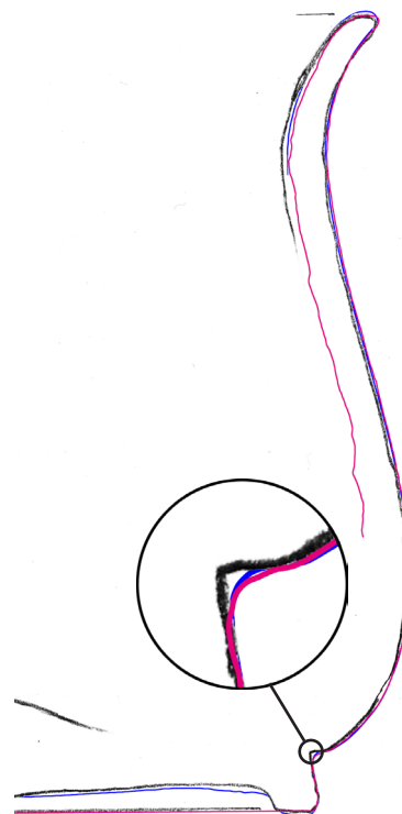
Die Genauigkeit der verschiedenen Verfahren ist im Vergleich gut erkennbar (schwarz: Handzeichnung. rot: Fotogrammetrie. blau: Weißlichtscan)
