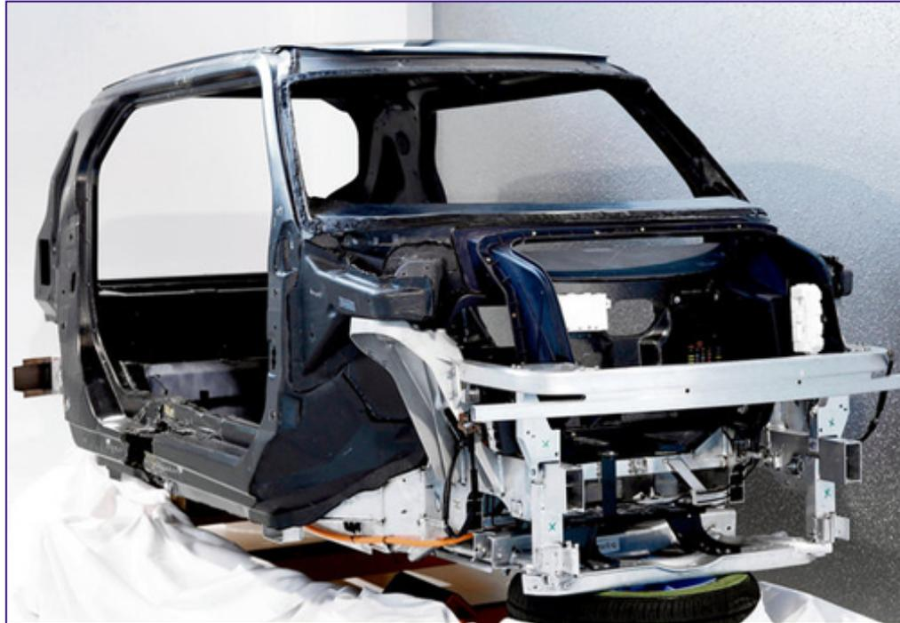
Prototyp einer Fahrgastzelle für das Elektromobil Megacity Vehicle (MCV) der BMW AG
