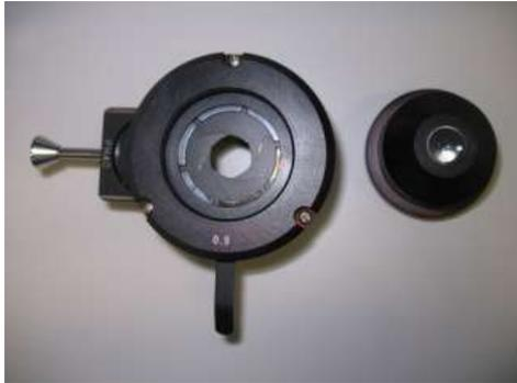
Abb.: Die halb geschlossene Kondensorblende im ausgebauten Kondensor. Der Hebel zur Einstellung der Irisblende zeigt nach unten. Die Kondensorlinse (links neben dem Kondensor) ist abgeschraubt.
