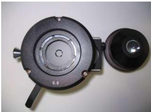
Abb.: Die Ringblende im ausgebauten Kondensor. Die Kondensorblende muss vollständig geöffnet sein (Der Hebel zeigt nach links unten).
