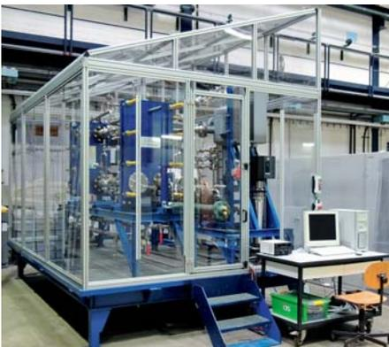
Diese Ammoniak-Wasser-Wärmepumpe im Technikums-Maßstab kann Abwärme aus Industrieprozessen bei bis zu 80 Grad zurückgewinnen.
