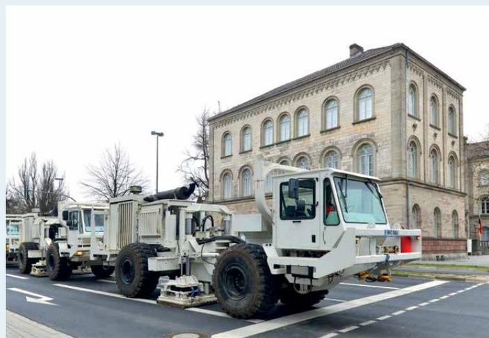
Spezialfahrzeuge für die 2D-Seismik im Rahmen der Untersuchungen zur Tiefengeothermie
