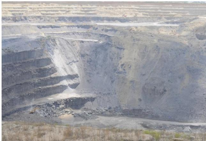
Abbildung 3: Einblick in die Mine. Links Terrassensprengung, rechts führte eine Sprengung durch fehlerhafte Vorbereitung zu Rutschungen.
