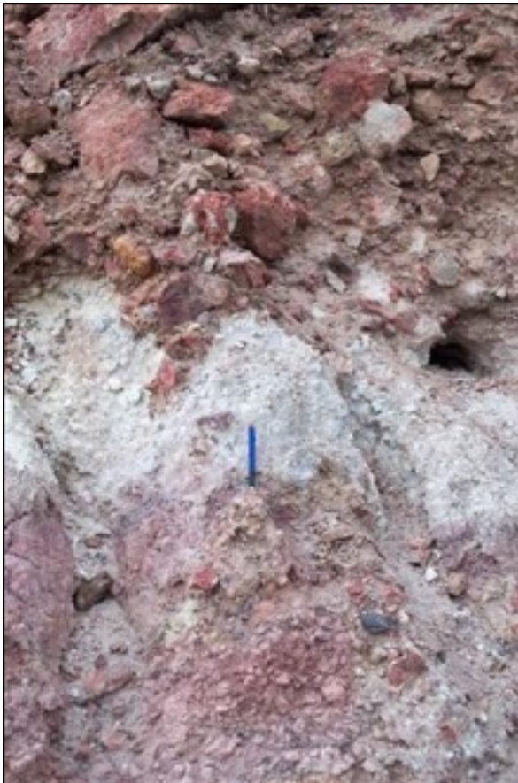
Abb. 53: Verwitterter, ausgelaugter Basalt (links), grüner Abschrecksaum um ein gelb verwittertes Basalt-Pillow (rechts)
