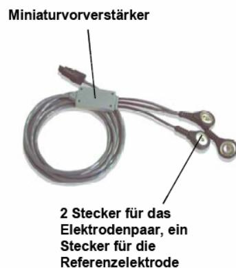
**Abb. 3.14. Exemplarisches Messkabel der EMG-Messung**
