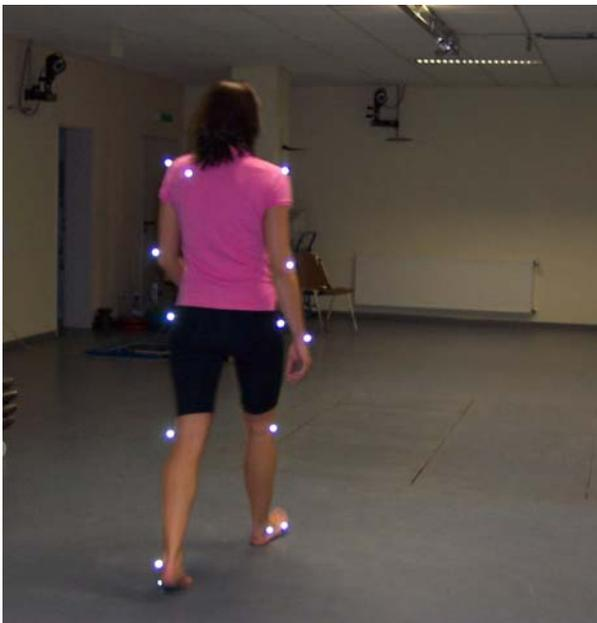
**Abb. 3.24. Angebrachte Marker am Probanden (während einer Ganganalyse)**
