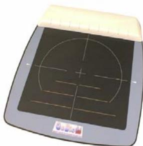
**Abb. 3.25. Fußdruckmessplatte**
