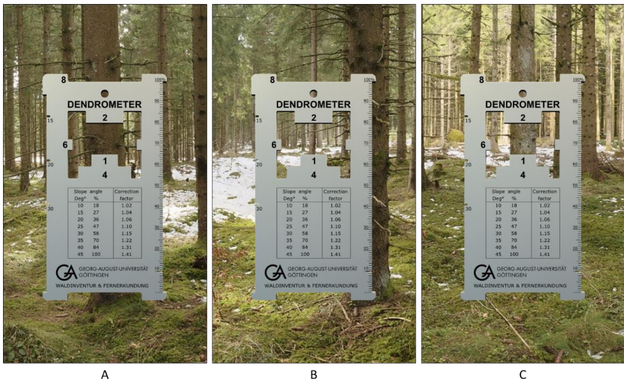
Abbildung 3. Winkelzählprobe mit dem Zählerfaktor 1: A ist ein gezählter Baum, B ist außerhalb und C ist ein Grenzbaum.
