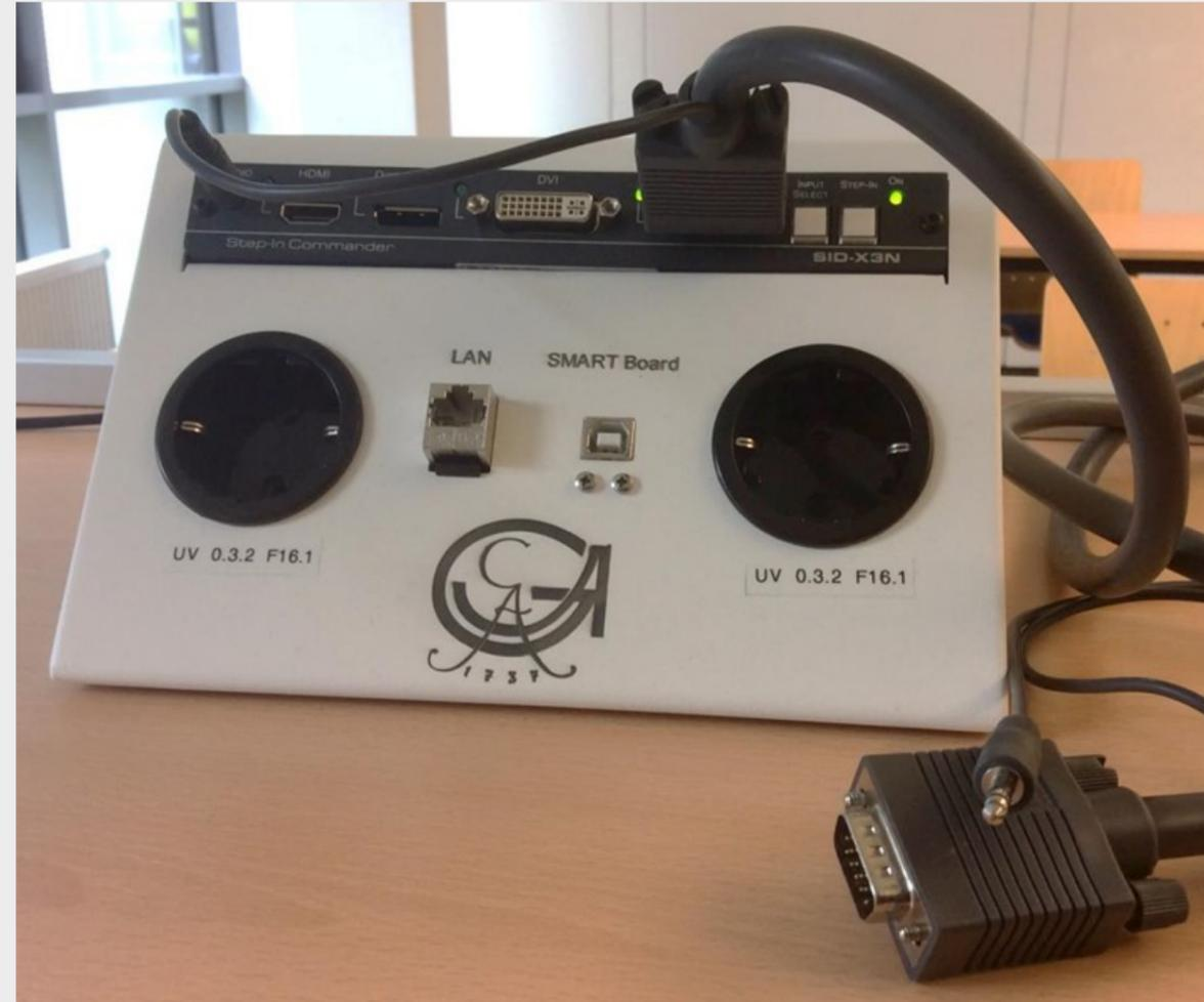
*Achtung:* Eine Audioeinspeisung das Klinken-Kabel (Audiokabel) funktioniert nur, wenn zusammen mit der Videoquelle VGA. Nur Audio z.B. SmartPhone funktioniert nicht!
