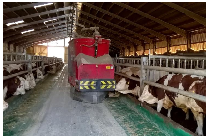
Abb. 1 Mastrinderstall mit Futterroboter (Triomatic HP 2 300, Trioliet, Oldenzaal, Niederlande).
