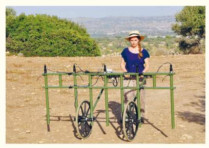
Magnetometer: Suche nach verdeckten antiken Strukturen unter der Oberfläche.
