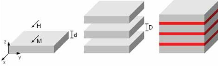
**Abbildung 2.1: Homogener Film, Vielfachschichten und Schichtpakete.** Eine homogene Schicht (links) kann als einfachstes Beispiel für einen magnonischen Kristall gesehen werden. Erweiterungen hiervon sind Vielfachschichten mit gleichem Material und großen Abständen (Mitte) oder Schichtpakete aus ferromagnetischen und nichtmagnetischen Materialien mit kleinen Abständen (rechts).
