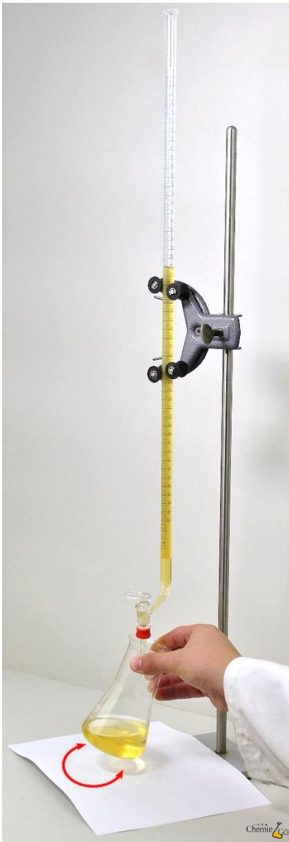
Bei einer Titration wird der Erlenmeyerkolben bei Zugabe der Maßlösung leicht geschwenkt, so dass sich Proben- und Maßlösung gut mischen.
