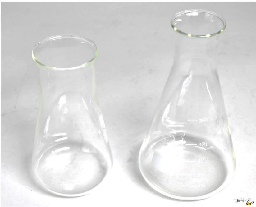
Ein Erlenmeyerkolben ist ein Glasgefäß mit einem flachen Boden und einem nach oben hin enger werdenden Hals.
