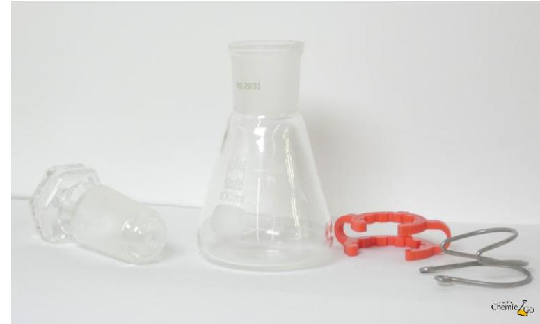
Der Stopfen kann mittels einer Klemme (HWS-Klemme oder Keck-Klemme aus Kunststoff, rechts) gesichert werden.
