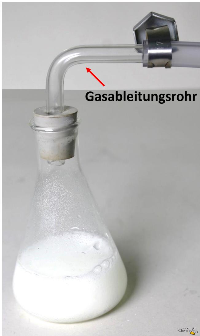
Des Weiteren können Erlenmeyerkolben auch bei Reaktionen genutzt werden (z. B. für eine Gasentwicklungsreaktion).
