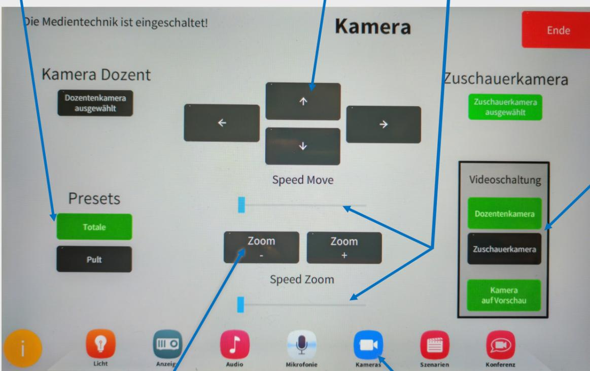
Hier legen Sie fest, welche Kamera auf dem Vorschaumonitor (Monitor am Pult) angezeigt wird. Dieses Signal wird als Kamerasignal an den PC geleitet und ist somit in der Webkonferenz als Webcam sichtbar. Damit ein Kamerabild am PC ankommt muss also „Kamera auf Vorschau“ aktiviert sein und das Kamerabild auf dem Vorschau-monitor sichtbar sein.
