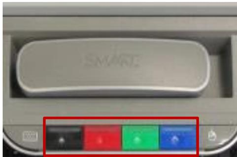
Verwenden Sie die Farbtasten um die Software „SMART Ink“ zu öffnen.
