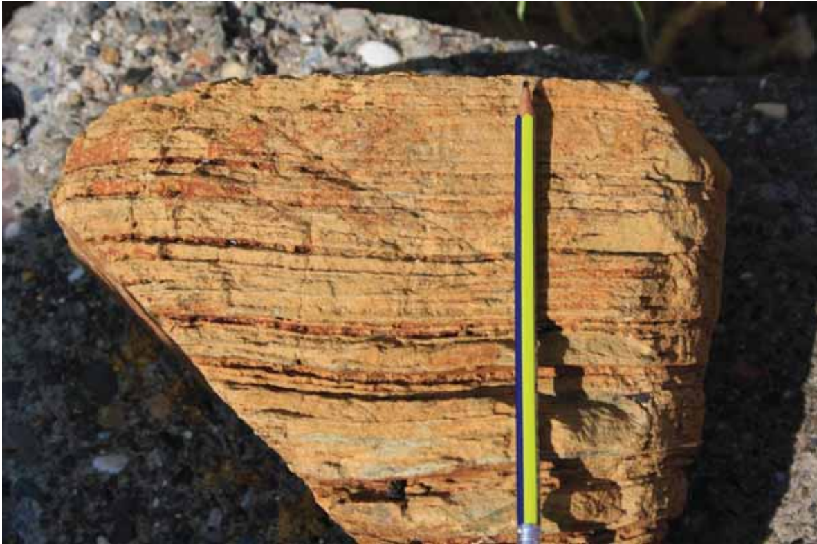
Abbildung 39: Verwitterter Periodotit mit deutlicher Foliation
