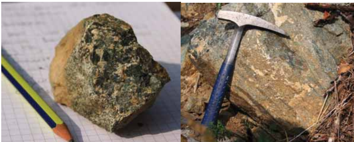
Abbildung 31: Gabbro mit deutlichem Lagenbau und Orthopyroxenen.
