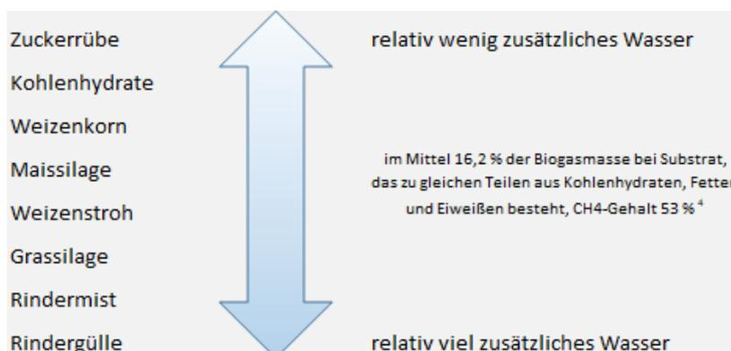
**Abbildung 35: qualitative Auswertung des Wasserbedarfs unterschiedlicher Substrate für die Umsetzung zu Biogas**
