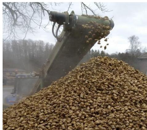
Abbildung 2 b: Pellets aus teilmobiler Pressung
