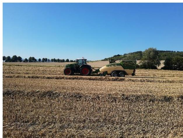
**Abbildung 50: Teil-mobile und mobile Pelletierung mit einer Krone Premos**
