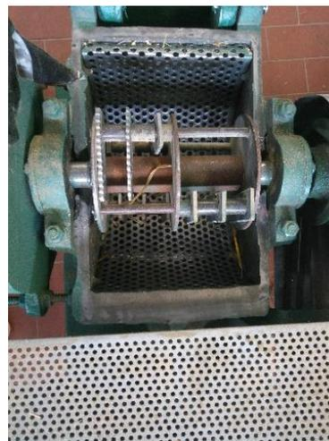
Abbildung 17: Hammermühle zur Vorzerkleinerung des Strohs aus Strohballen
