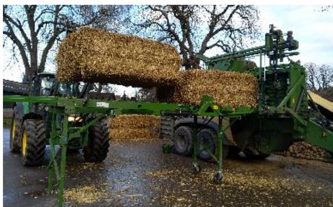
Abbildung 2: Teilmobile Pelletherstellung
