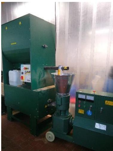
Abbildung 16: Pelletieranlage im Technikum der HAWK
