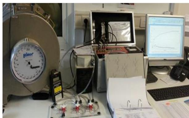
Abbildung 12: Biogasmessgerät und Trommelgaszähler zur Bestimmung der Biogasqualität und -quantität
