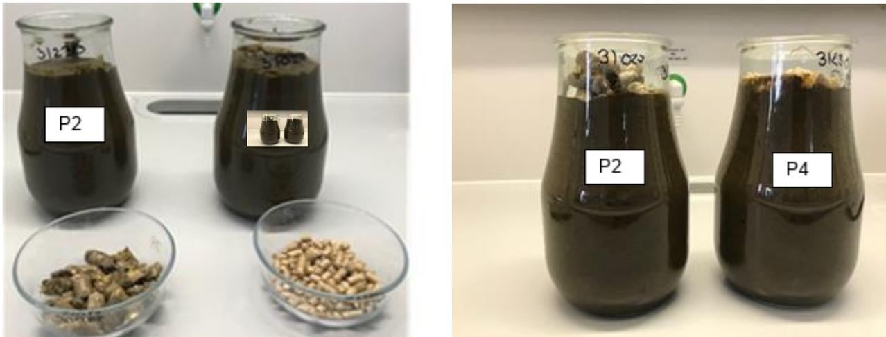
Abbildung 7: Auflöseverhalten der Strohpellets P2 und P4 in Gärrest
