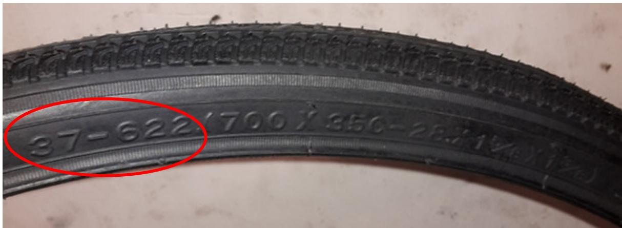
图中被红色圈起来的就是这条外胎的标准尺寸。内径 622 毫米的外胎外径大约 700 毫米，因此在其他的尺寸标注体系中也会使用外径（就是括号中的 700）
