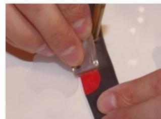
如果不知道漏气的位置在哪里的话，就将内胎充满气，置于水中观察，冒气泡的地方即为洞口。以含有酒精的湿纸巾，仔细地把漏气处的橡胶清除干净，然后用砂纸将漏气处稍微磨平，之后均匀抹上补胎专用胶，等干后，贴上补胎片（比漏气处大），推平压紧，必要时可在边缘再涂上一次专用胶。
