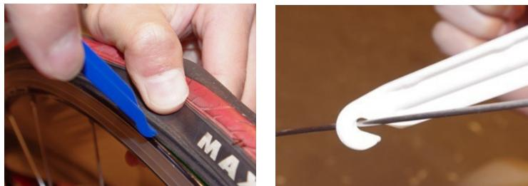
将其中一只轮胎撬杆插入外胎，利用杠杆的原理将外胎翻出后固定不动，撬杆可以挂在辐条上面。把撬杆成扇形打开，顺势绕一圈，将全外胎翻出轮框，必要时用手辅助。翻出外胎之后，将中间的内胎取出来，和气嘴连接的地方最后才取出来。
