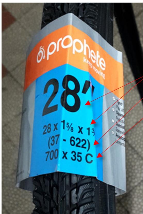
外胎的标签纸如左图所示，这个标签采用了外尺寸的标注方式。700 毫米对应大约 28 英寸，这就是最大的数字 28 的含义。
