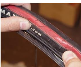
把补好的内胎装回去时，先打入一定程度的气，然后将内胎气嘴插入轮框上的气嘴孔，一点点小心地把内胎塞回轮框中。塞回内胎后，就可以把外胎卡回轮框至最紧的状态，将轮胎撬杆反向插入，如之前拆卸一样，过程中注意检查左右两侧胎缘与轮框之间是否有夹到内胎，最后一点外胎双指用力向里压入。
