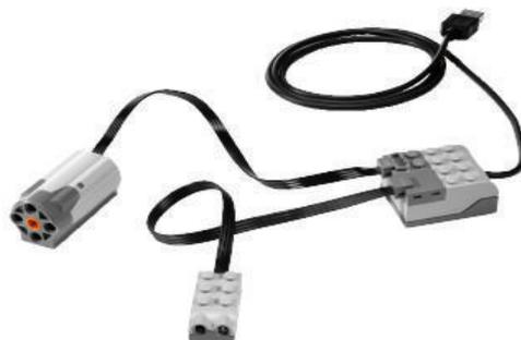
Das System enthält einen Neigungssensor, einen Entfernungssensor und einen Motor. Hiermit lassen sich kleine Lego-Miniwelten automatisieren. Beispielsweise haben Grundschüler in einer
