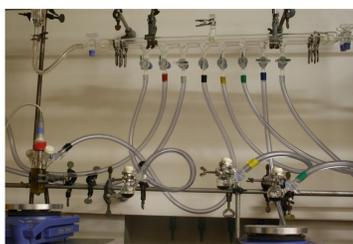
Die Schlenk-Linie besteht aus zwei parallelen Glasrohren; eines an Argon angeschlossen, das andere evakuiert. Durch Drehen der Patenthähne können einzelne Reaktionsgefäße über geeignete Schläuche unabhängig voneinander mit Argon befüllt oder evakuiert werden.
