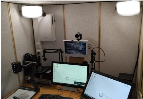
Die VBOX ist eine schallgedämmte Studiokabine, die mit professioneller Audio- und Videotechnik (AV-Technik) ausgestattet ist und eine ausgewogene Innenakustik hat. Die Innenakustik der VBOX sorgt für ein entspanntes Umfeld, in dem die externen Störungen ausgeblendet werden können. Auf diese Weise werden AV-Aufnahmen von hoher Qualität gewährleistet.
