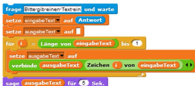
Abbildung 2: Implementierung von "Text rückwärts ausgeben" in Snap!
